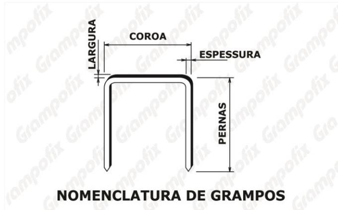
A coroa e a bitola do arame são importantes para determinar o modelo de grampeador em que o grampo pode ser utilizado. Normalmente, cada grampeador trabalha com um único tamanho de coroa e bitola sendo que o comprimento das pernas pode variar de acordo com a necessidade da aplicação, o poder de fixação, a espessura do material a ser grampeado e assim por diante. Cada grampeador costuma usar vários comprimentos diferentes.
