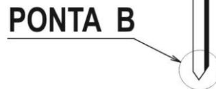
Estas pontas favorecem a penetração dos grampos de forma paralela e perpendicular. Também podem ser fabricadas pontas que se chamam divergentes e que tem o objetivo de aumentar a força de fixação. Esse corte especial serve para abrir as pernas dos grampos em forma de curva dentro do material, normalmente madeira, em vez de penetrar em linha reta.
